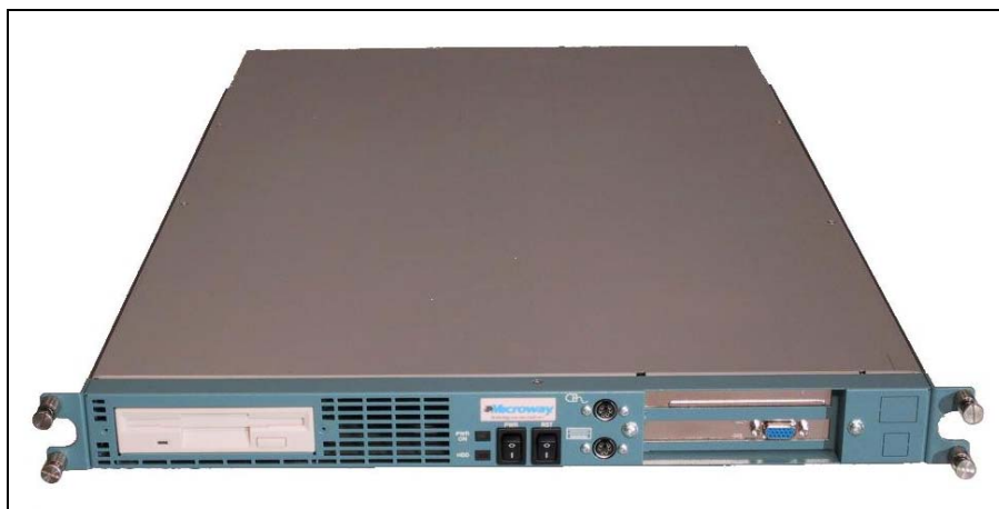
Sl. 3.8 Računar-segment za modularnu gradnju računarskih sistema
